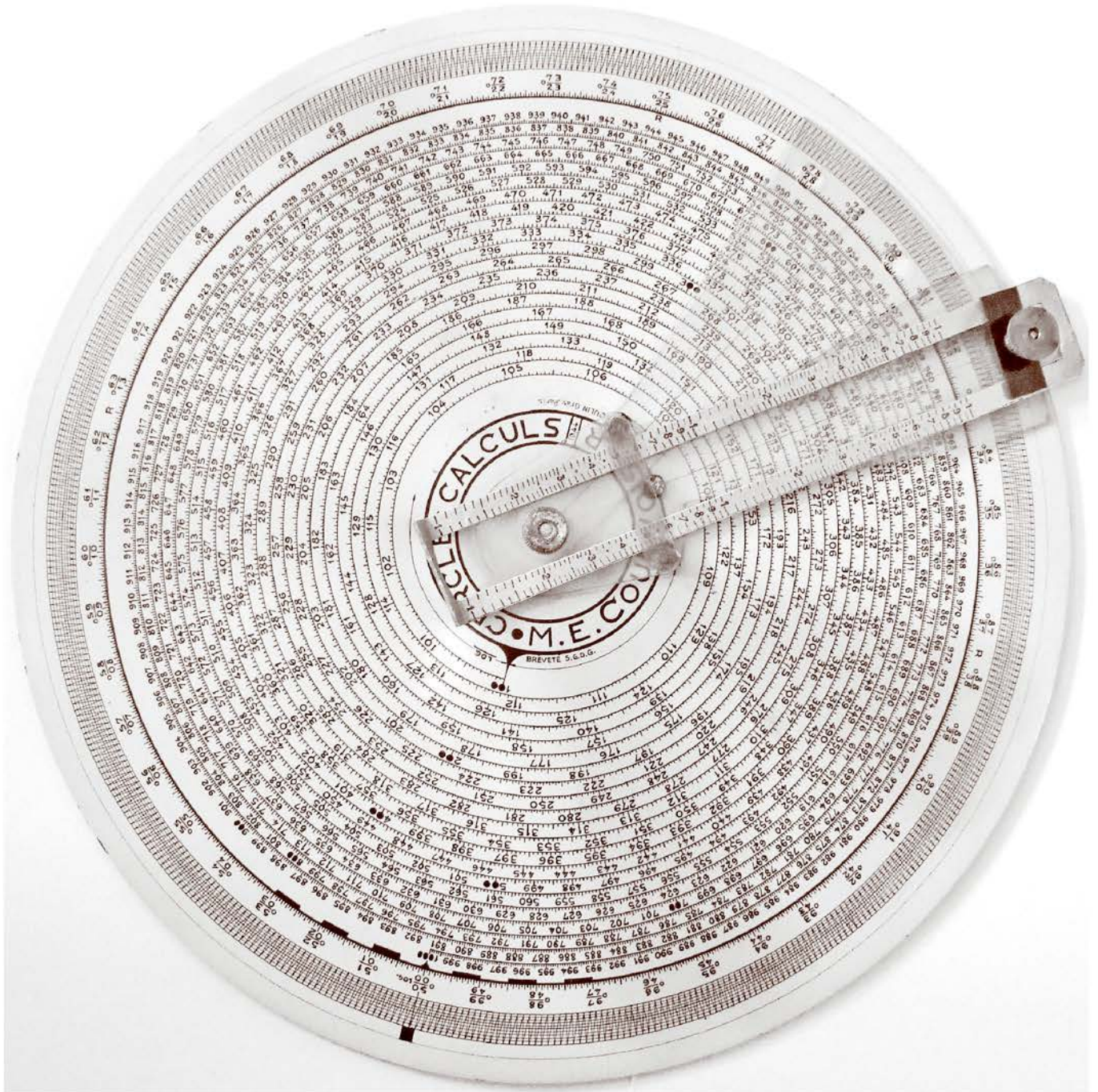
Figure 14. The Courvoisier Cercle à Calculs
