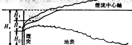
図-1 煙の上昇と拡散の様相 ( $H_0$ は煙突高度、 $H_m$ は運動量上昇度、 $H_f$ は浮力上昇高度、 $H_e$ は有効煙突高度)
